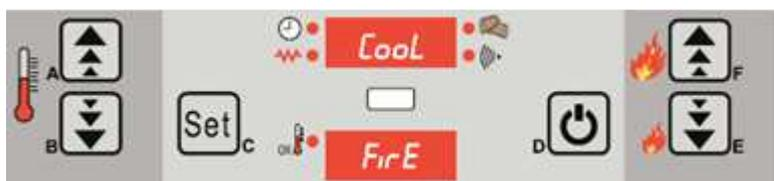
Lorsqu' une interruption de la tension se produit dans le réseau le message «Cool Fire" (absence courant électrique) est affiché. Après retour de la tension la cuisinière est en attente jusqu'à ce que la température fumée revienne à la normale.
