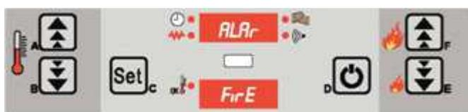
Il est affiché pendant la phase de travail si la flamme s'éteint, et que la température des fumées descend au-dessous du niveau minimum de fonctionnement.
