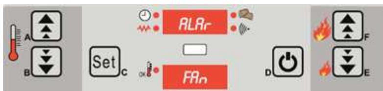
L'affichage ALAR FAN apparaît quand il ya une irrégularité dans le travail du ventilateur de fumée. Pendant la durée de l'alarme, le poêle effectue l'opération d'extinction.
