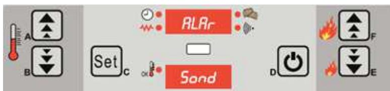
Affichage ALAR SOND le cas d'une défaillance ou d'une valeur de la sonde de détection de fumée anormale.
