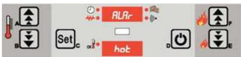
L'affichage ALARM HOT apparaît lorsque la sonde détecte la température des fumées est trop élevée. Attendre la diminution de la température pour un retour en fonctionnement normal.
