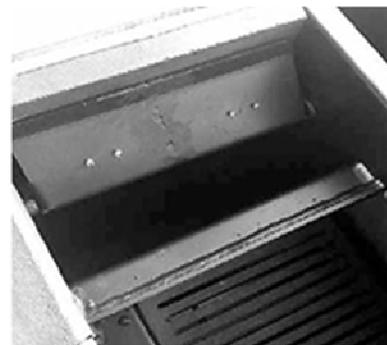
L'ouverture permet d'augmenter le tirage et d'accélérer la combustion.
