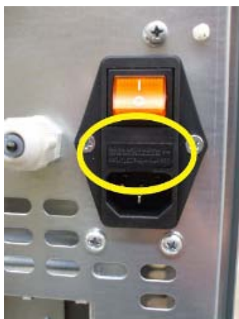
Fig. 90 - Hublot avec les fusibles à enlever
