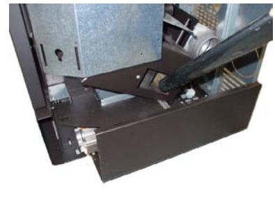
Fig. 83 - Nettoyage de la chambre des fumées
