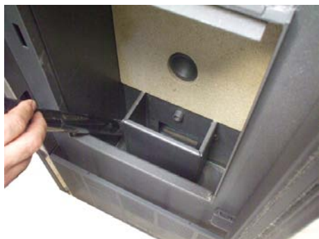
Fig. 60 - Nettoyage l'espace du brasero
