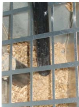
Fig. 62 - Nettoyage réservoir et vis sans fin
