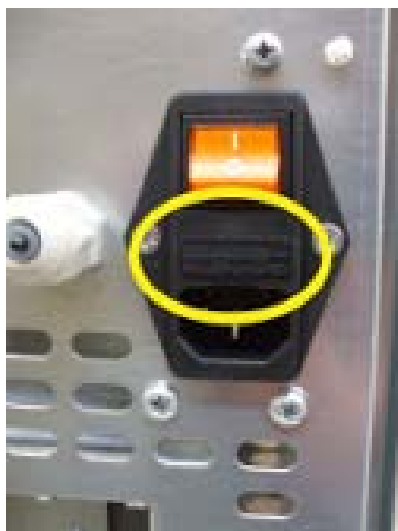
Fig. 43 - Hublot avec les fusibles à enlever
