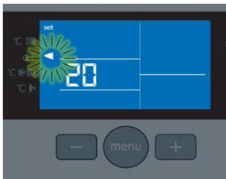
Ce paramètre permet de modifier le delta de température de coupure du ventilateur.
