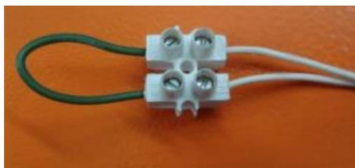
Un contact est prévu pour le raccordement d'un thermostat d'ambiance. Il s'agit d'un contact sec, normalement fermé (présence d'un pont) qui agit sur le circulateur chauffage.
