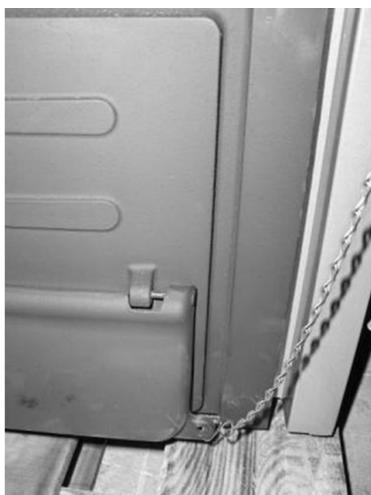
Mettre la tige de commande dans le régulateur de tirage et la maintenir à l'aide la vis de fixation.
