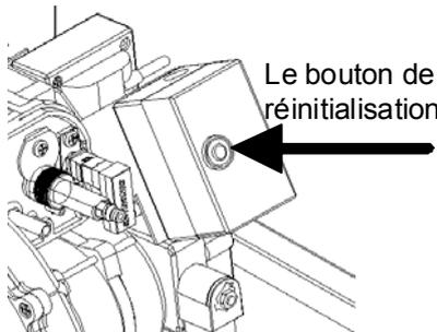
Cet élément principal permet de réarmer les modes de fonctionnement brûleur. Il assure aussi l'activation ou la désactivation des fonctions diagnostiques citées ci-après par l'intermédiaire de la LED multicolore. La LED, se situent sous le bouton transparent de réinitialisation. *En service normal, les différents états de fonctionnement sont affichés au travers d'un code couleur suivant.*
