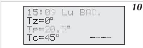
Image 10 Vue générale en configuration „C.C.NON BAC. OUI” (Mode chauffage central débranché, mode e.c.s. inclus)
