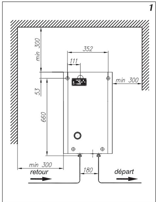
Image 1 Installation de la chaudière sur le mur
