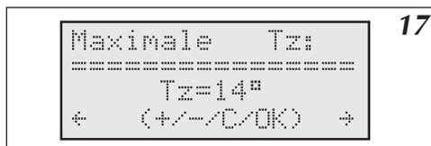
Image 17 Réglage de la température extérieure (été hiver) (Maximale Tz)
