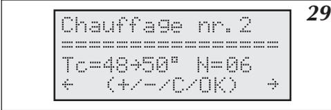
Image 29 Page chauffage du deuxième circuit (Chauffage nr.2)
