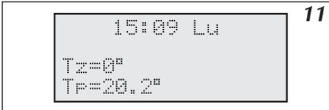
Image 11 Vue générale en configuration „C.C.NON BAC. NON” (Mode chauffage central et e.c.s. débranchés)
