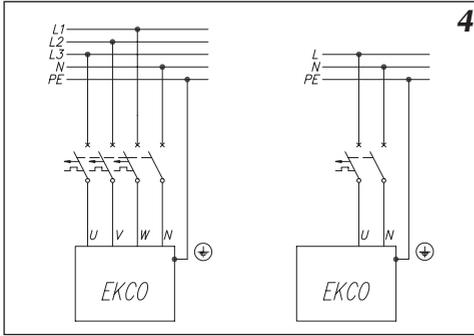
Image 4 Raccordement électrique
