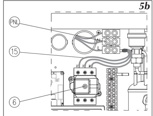
Image 5b. Branchement au réseau électrique monophasé (concerne des chaudières modélé MT avec des puissances 4, 6, 8 kW et modélé „M” de 12kW ).
