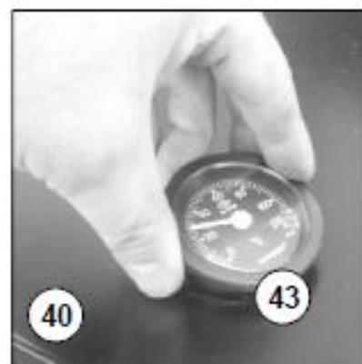
Insérer le bulbe de thermomètre (43) dans le doigt de gant (8) prévue sur l'élément avant (1).
